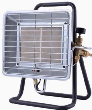
La stufa a gas FGHX 145 ha una capacità di riscaldamento massima di 3.5 kW. Riscalda un volume di 70 m<sup>3</sup> (28 m<sup>2</sup>) usando una bombola a gas standard di max 15 kg (non fornita). Il suo sistema a infrarossi riscalda istantaneamente la stanza.
