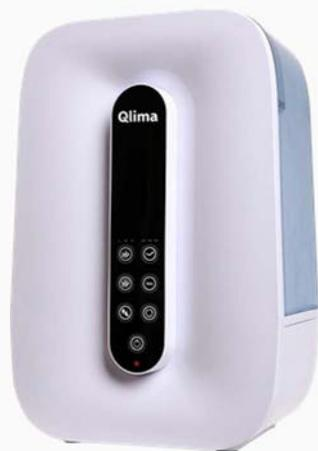
L'umidificatore H 609 ha una capacità di evaporazione di 4.8 litri per 24 ore. È adatto per ambienti fino a 125 m<sup>3</sup>. Dotato di doppia tecnologia elettrica ed ultrasonica, questo modello consente di scegliere tra l'opzione vapore fresco o vapore caldo.
