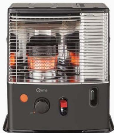
Il modello R 4224S TC-2 è una stufa a stoppino e funziona senza elettricità. Fornisce una potenza unica di 2.4 kW per riscaldare un'ampia stanza, opportunamente ventilata, da 40 a 85 m<sup>3</sup>.
