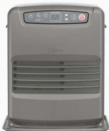
La stufa Laser SRE 0031 TC è provvista di un sistema di controllo elettronico e, per il funzionamento, necessita di una presa di corrente. La potenza si adegua automaticamente tra 1.08 kW e 3.1 kW e consente di scaldare ambienti da 50 a 120 m<sup>3</sup>.
